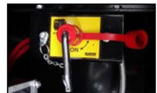
**Sicherheit:** ON-OFF Batterieschalter: abnehmbarer Griff, damit das Aggregat nicht manipuliert werden kann.
